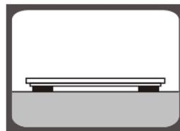
Paso 1. Para asegurar precisión, coloque la balanza sobre una superficie firme y plana. Evite apoyarla sobre alfombras o superficies suaves.
