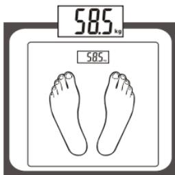
Paso 2. Súbase a la balanza suavemente; la balanza se encenderá automáticamente. Permanezca parado sobre la balanza sin moverse y espere hasta que su peso en la pantalla se estabilice y el valor quede fijo.
